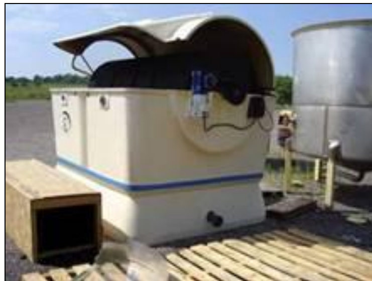
Figura 59 - Exemplo de um reator com biodisco. Fonte: http://www.snatural.com.br/
