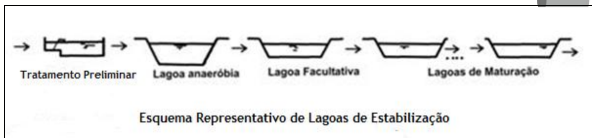
Figura 55– Esquema representativo de Lagoas de Estabilização Fonte: Google Imagens
